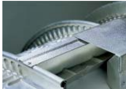
Afsluiting van de Kalzip® baan in de nok met sluitstukken, vormvullers en een op de bouwplaats uitgevoerde omzetting van de Kalzip® bodem. In een kleine straal rond geknikte Kalzip® als alternatief voor dakranden
