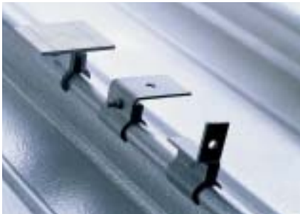
Looppaden, zonnepanelen, bliksemafleidingsnetten, veiligheidssystemen enz. worden met Kalzip® klemmen bestaande uit roestvast staal of aluminium eenvoudig op de kralen bevestigd zonder dat de dakhuid wordt doorboord
